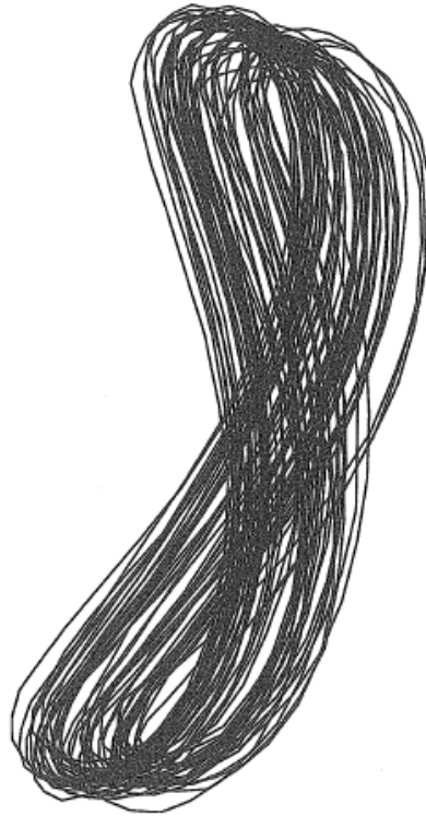
FIG. 4.31 – Vibrations induites par le détachement tourbillonnaire. Exemple de trajectoire.
